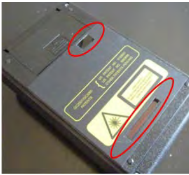
El lado trasero del GC3000 con las dos lentes circulado. Utilice el aire comprimido limpio para limpiar las lentes.
